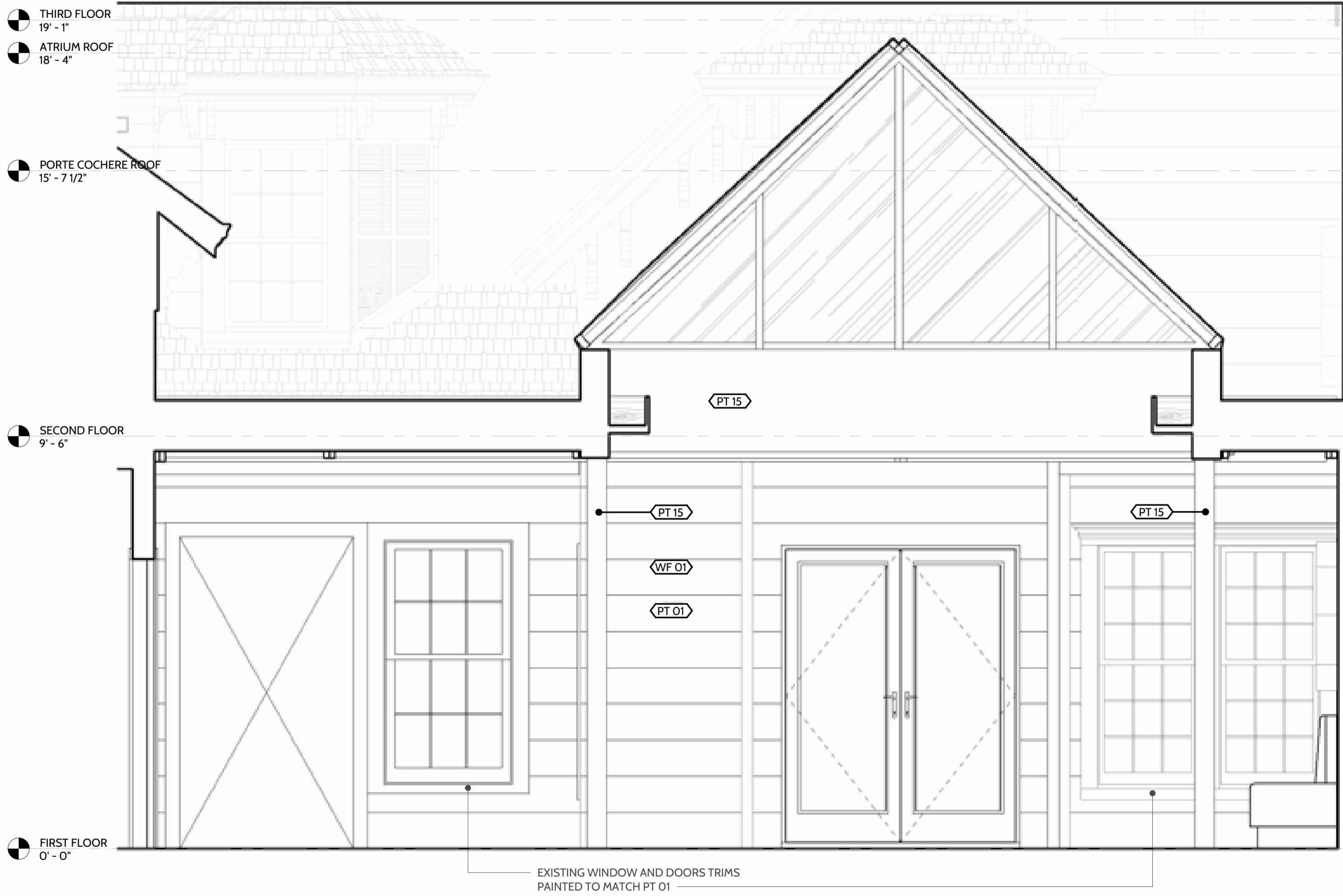
2 ATRIUM E INTERIOR ELEVATION SCALE: 1/2" = 1'-0"
